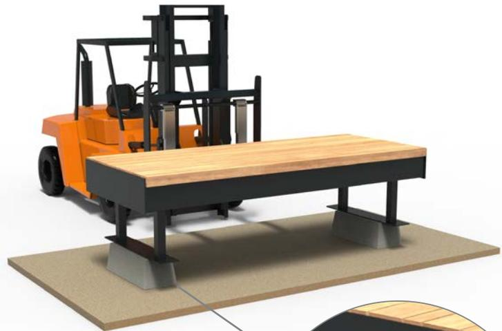
**Passt auf!** Um Schäden am Produkt zu vermeiden, empfehlen wir, die Gabeln des Gabelstaplers mit Schutzmaterial zu versehen.
